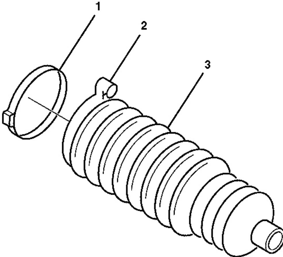
**Fig. 25: View Of Boot Clamp And Rack & Pinion Boot**
